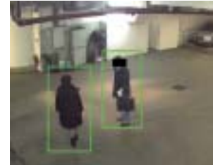
Personendetektion im Video unter Verwendung des „Histogram of Oriented Gradient“-Verfahrens
